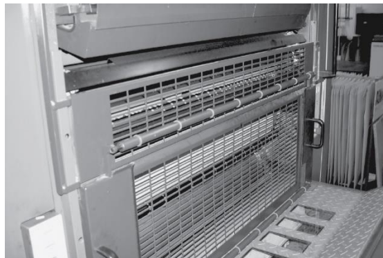
شكل رقم ٢٠: يبين وحدة طباعية من ماكينة أوفست مع شبكات الحماية في وضع الإغلاق
