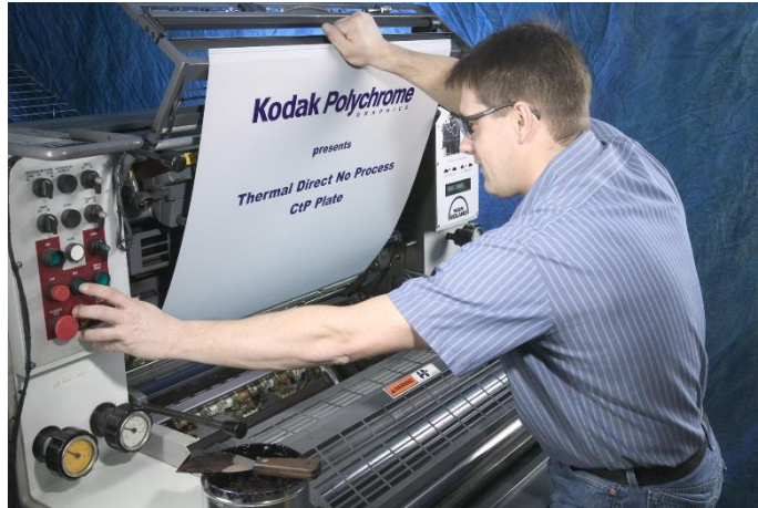
شكل رقم ٥١: تركيب اللوح الطباعي
